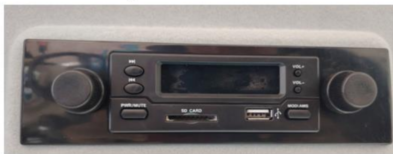
Rádio-Bluetooth-USB multimediální přehrávač Tlačítka pro ovládání Tlačítka vpravo a vlevo slouží k nastavení hlasitosti
