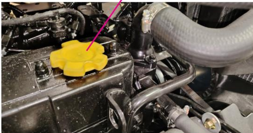
Obr. 14 Umístění filtrů a hrdla oleje
