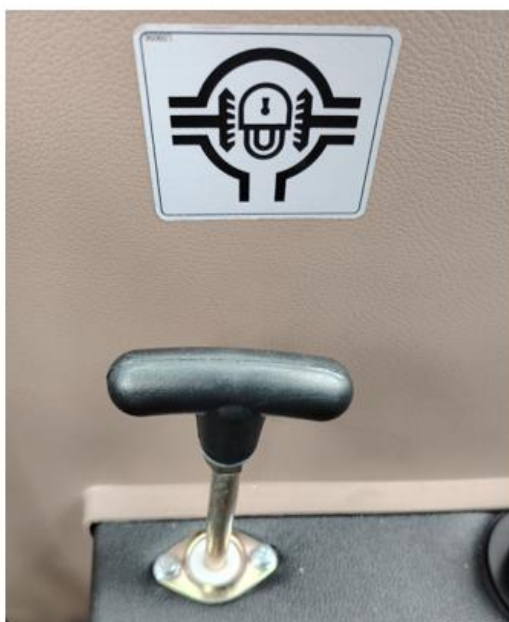
Obr. 12 Zapnutí/vypnutí předního náhonu, uzávěrka diferenciálu
