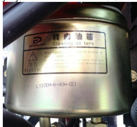
Obrázek 5-5 Kontrola hladiny oleje v olejové nádrži řízení
