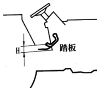
Obrázek 5-4 Montáž brzdového pedálu
