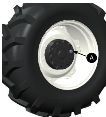
Obrázek 5-21 Kontrola hladiny oleje v koncovém pohonu přední hnací nápravy
