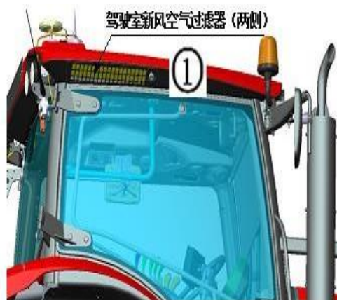
Obrázek 4-28 Přívod venkovního vzduchu
