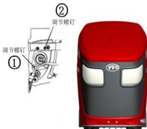
Obrázek 4-45 Nastavení křivky rozložení světla světlometu
